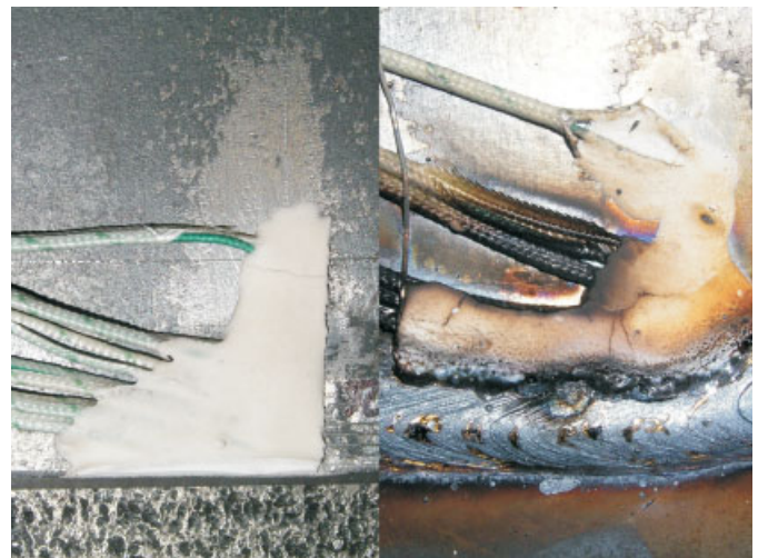
Bild 9. Applizierte Thermoelemente vor und nach dem Versuch
