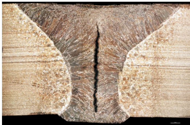
Bild 6. Schliffbild einer unter Bewegung geschweißten Naht (Frequenz 0,25 Hz, Amplitude 0,2 mm)
