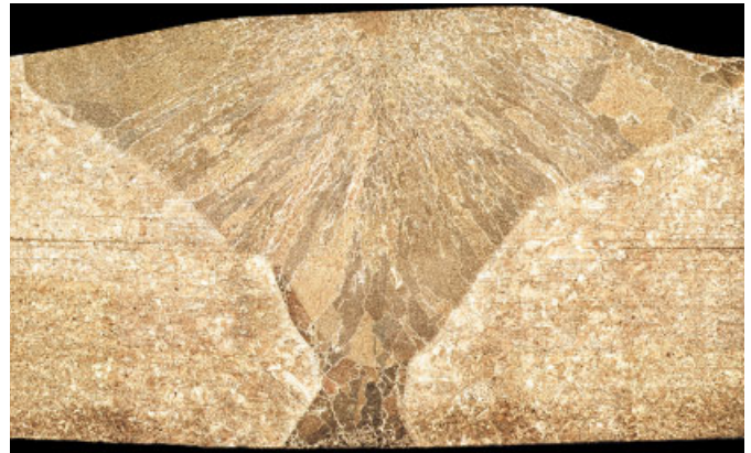
Bild 15. Schlifffeld einer mittels Plasmaschweißverfahren wieder aufgeschmolzenen Naht
